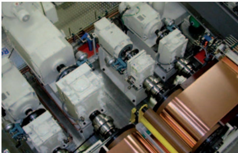
Diese von Burghardt+Schmidt GmbH gebaute und von DAA Delta Technik durchgängig automatisierte Streck-Biege-Richtanlage eignet sich für Blechbänder in diversen Qualitäten.
